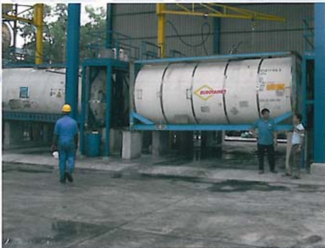
Stacja czyszczenia zbiorników dla mycia kontenerów wewnątrz.
