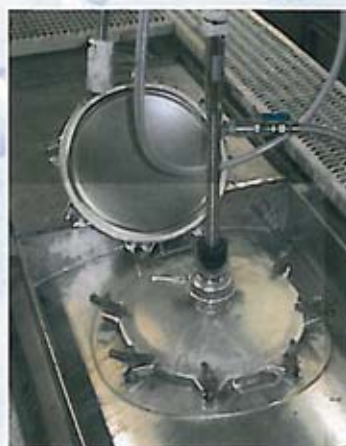
Głowica czyszcząca na 20' kontenerze podczas czyszczenia.
