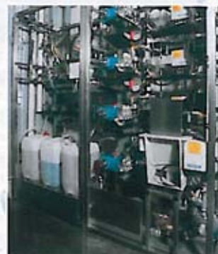
Urządzenie czteropompowe z różnymi systemami dozowania.
