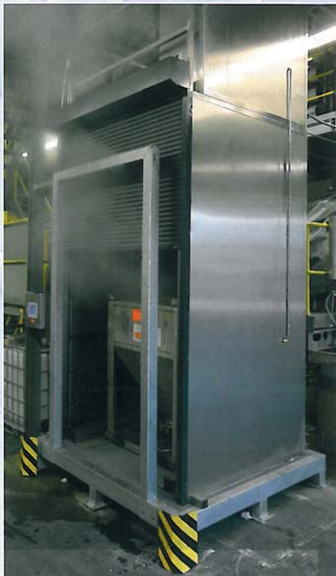
W pełni zautomatyzowane urządzenie czyszczące dla kontenerów IBC.
