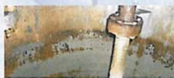
Zabrudzone zbiorniki reaktora ze stwardniałym brudem przed czyszczeniem.
