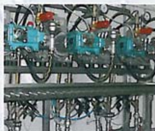
Wysokociśnieniowe agregaty pompowe do czyszczenia.
